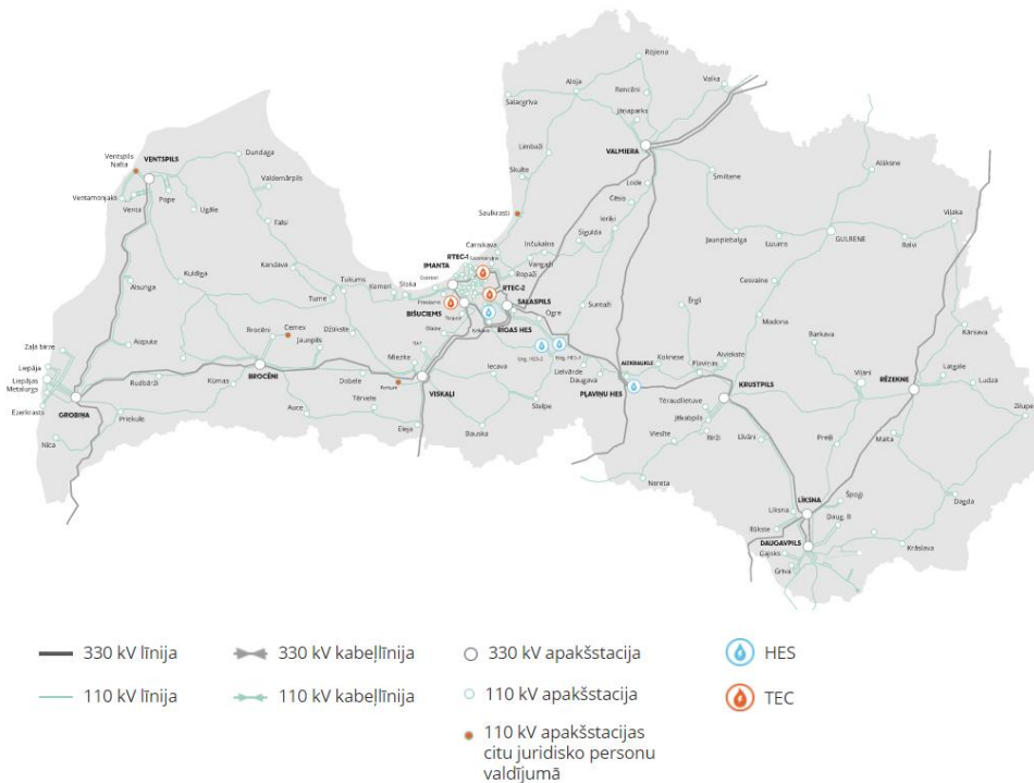
28.attēls. Latvijas 330 kV un 110 kV elektrisko tīklu shēma 85
